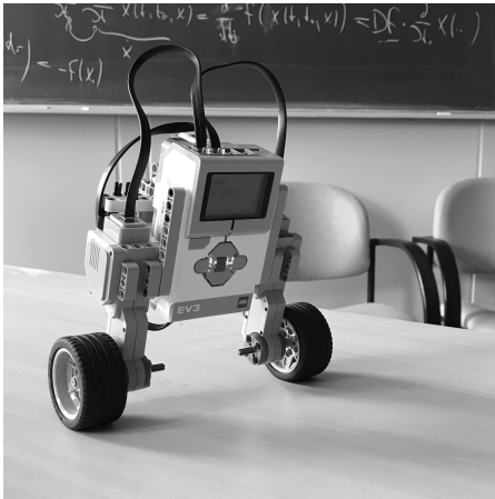
Abbildung 5.4: Ein im Fachpraktikum bei T. Damm entstandener sich selbst regelnder Segway (links). Eine Simulation von mikroskopischen Fussgängern, die ein Straßensegment mit einer Autodichte überqueren aus der Doktorarbeit von A. Meurer geschrieben bei A. Klar (rechts).
